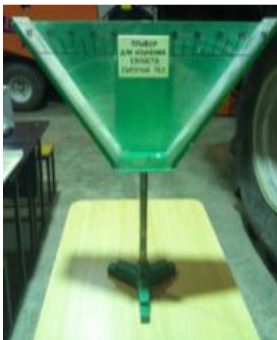
Рисунок 3 – Прибор для определения угла естественного откоса семян
