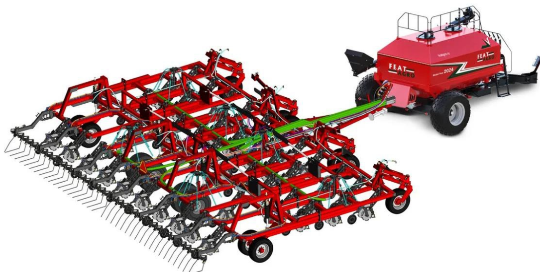
Рисунок 6 – Общий вид посевного комплекса FEAT AGRO APU
