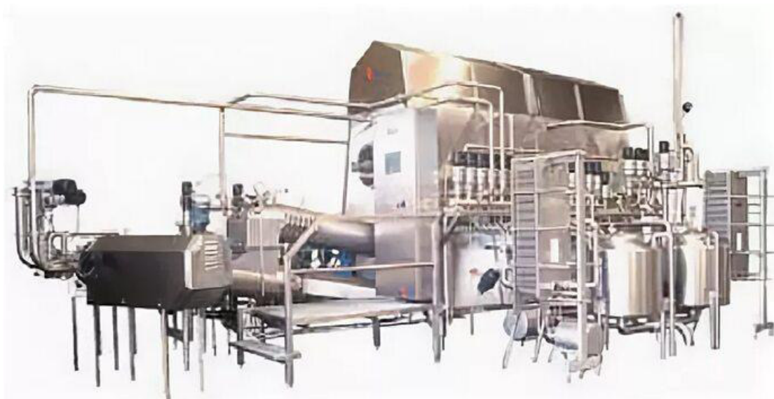
Рисунок 1 – Линия производства сливочного масла методом сбивания
