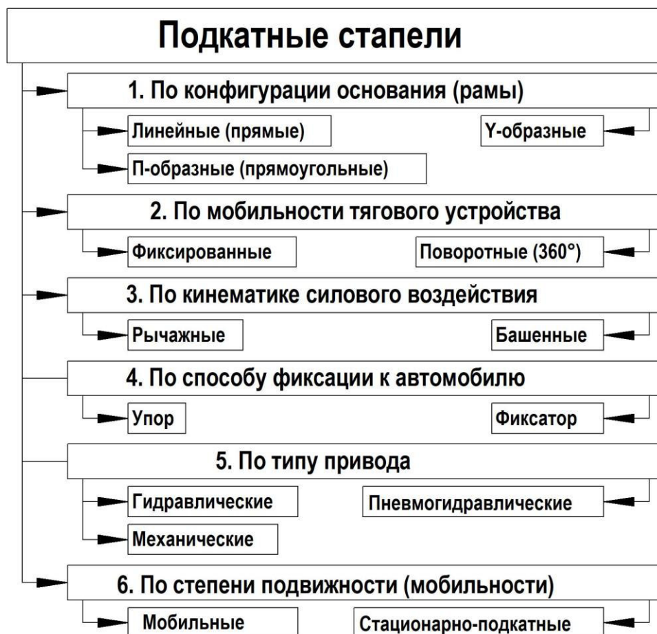
Рисунок 2 – Классификация подкатных стапелей
