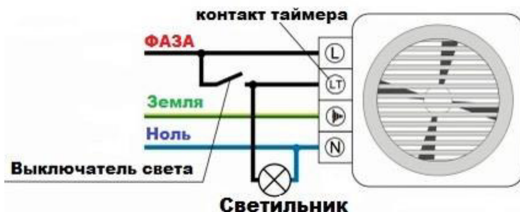
Рисунок 2 – Схема подключения вентилятора со встроенным таймером
