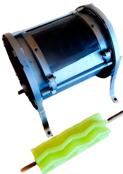
Рисунок 2 – Маслоизготовитель периодического действия с роторно-лопастным рабочим органом
