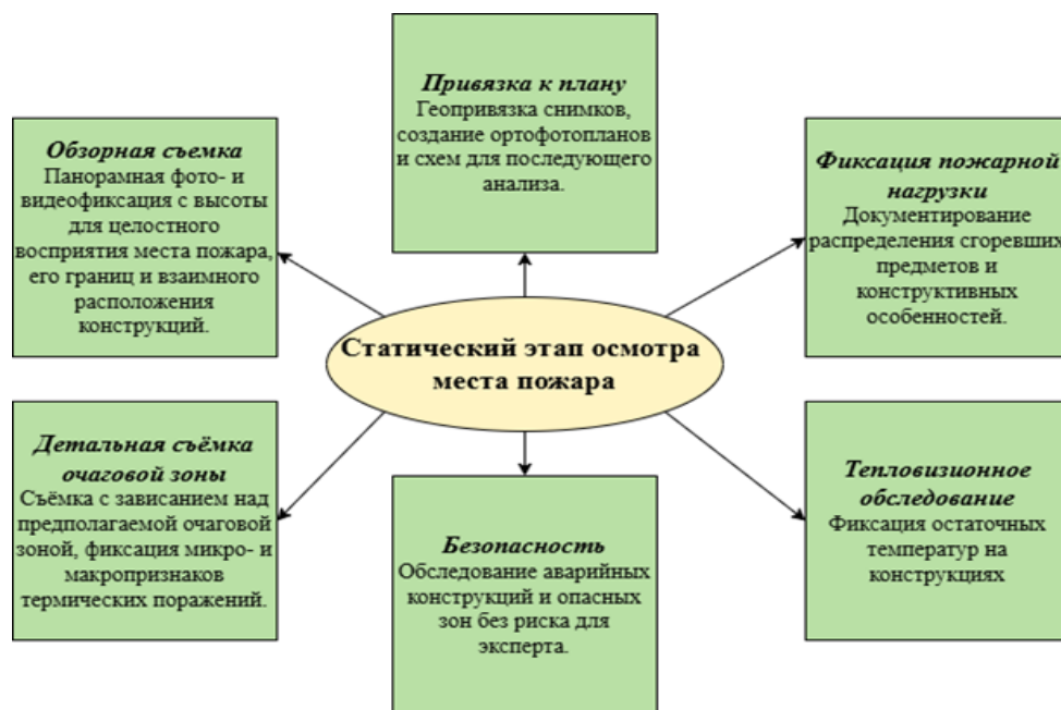
Рисунок 1 - Основные направления применения БВС мультироторного типа на статическом этапе осмотра
