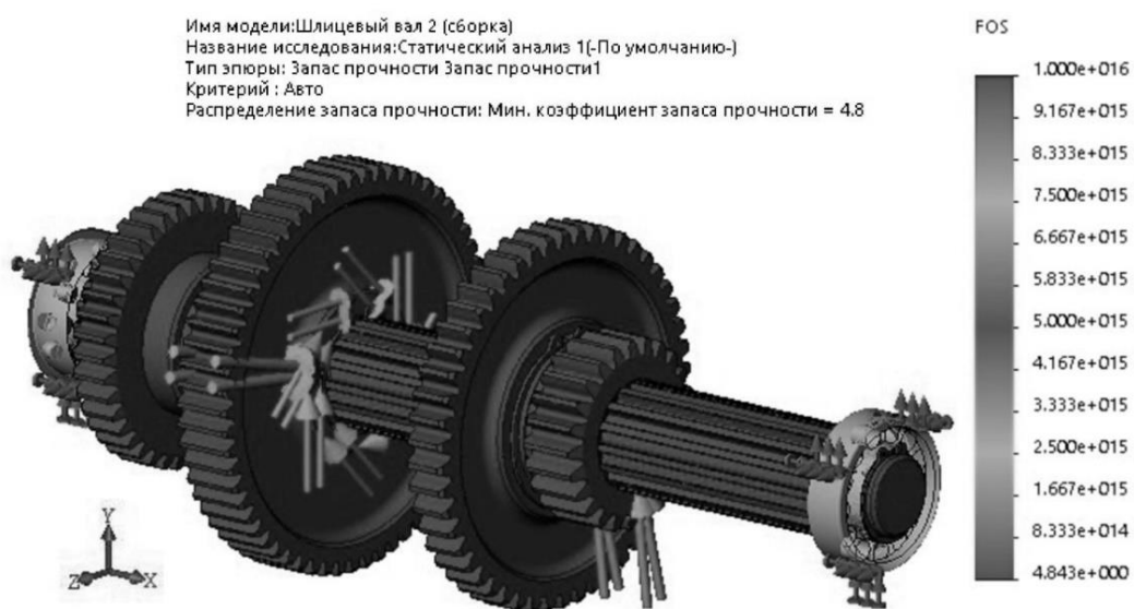
Рисунок 4 – Эпюра распределения запаса прочности узла привода главного движения
