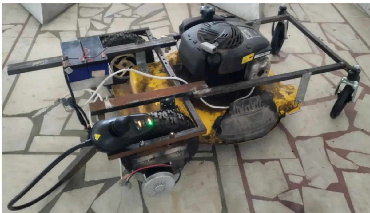
Рисунок 1 - Разработанный робот- мульчер на этапе тестирования
