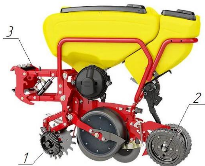
Рисунок 8 - Секция сеялки Väderstad Tempo R8, адаптированная под минимальную технологию посева: 1 – роторный очиститель; 2 – колеса заделывающие с протектором; 3 – гидроцилиндр догрузки секции
