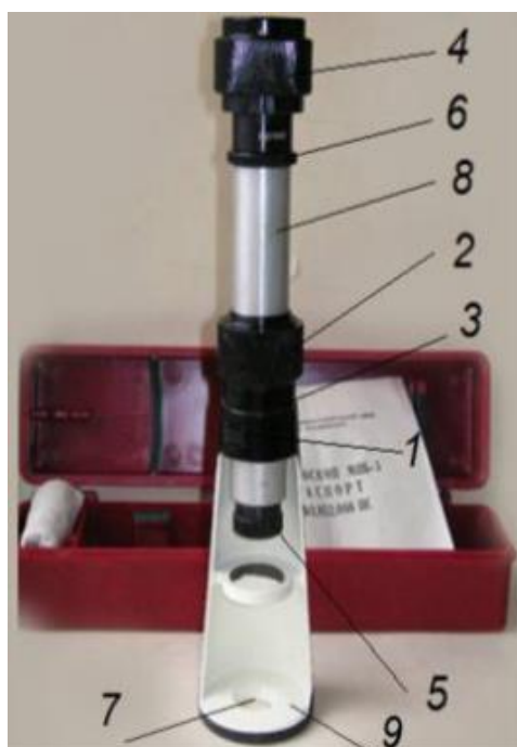
Рисунок 4 – Общий вид микроскопа МПБ-3: 1 – колонка; 2 – установочное кольцо; 3 – тубус; 4 – окуляр; 5 – объектив; 6 – сетка; 7 – отверстие в основании; 8 – труба тубуса; 9 – основание
