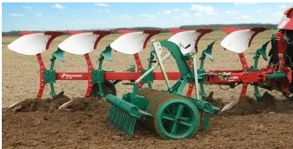
Рисунок 2 - Общий вид почвоуплотнителя Raskomat, включающего дополнительно 2 ряда пружинных пальцев
