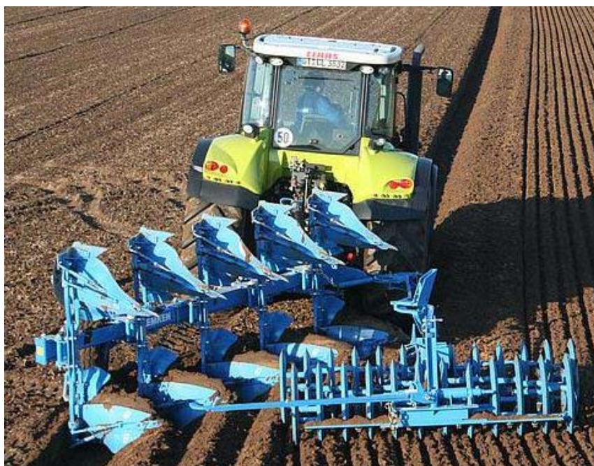
Рисунок 6 - Общий вид почвоуплотнителя VarioPack, состоящего из тандемной батареи колец V-профиля
