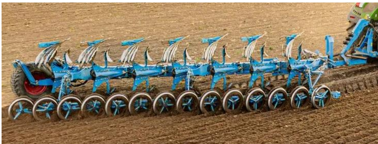
Рисунок 5 - Общий вид почвоуплотнителя FlexPack, состоящего из сдвоенных колец V-профиля
