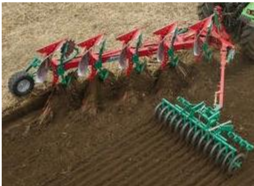
Рисунок 1 - Общий вид почвоуплотнителя Раскомат, состоящего из батареи колец V-профиля
