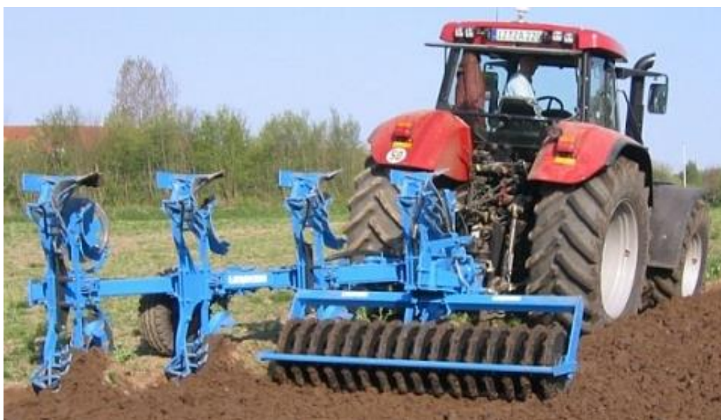
Рисунок 4 - Общий вид почвоуплотнителя FixPack, состоящего из батареи прорезиненных колец трапециевидного профиля
