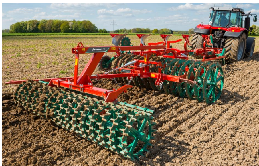
Рисунок 3 - Общий вид почвоуплотнителя Raskomat, состоящего из батареи колец V-профиля и батареи кольчато-шпоровых катков
