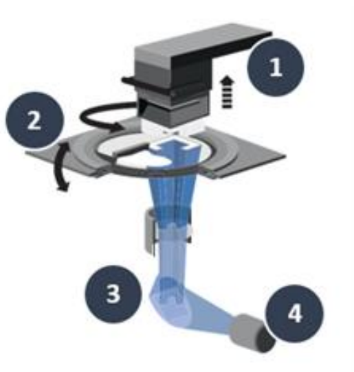
Рисунок 1 – Принципиальная схема LCM-технологии компании Lithoz: 1) платформа построения; 2) ванна с суспензией; 3) оптическая система; 4) LED-проектор.
