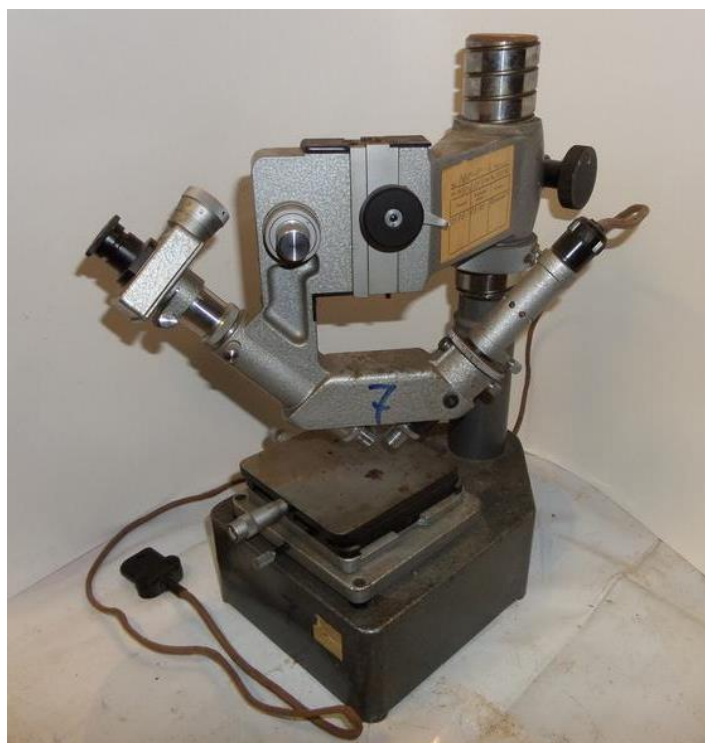
Рисунок 2 – Общий вид двойного инструментального микроскопа МИС-11
